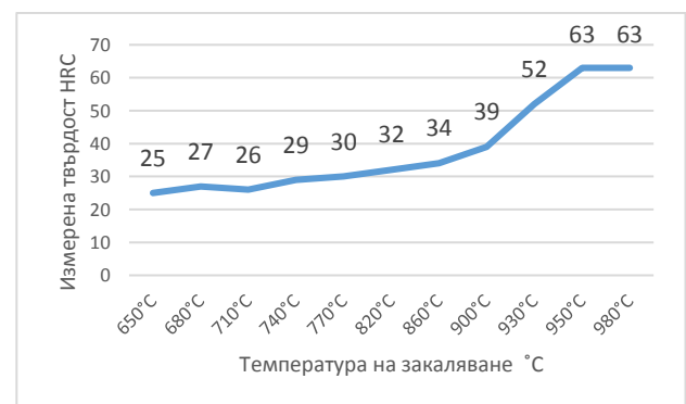
Графика 3 Проби от стомана марка X12 охлаждање във вода
