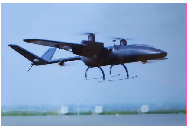
Фиг. 11 Проект за безпилотен ЛА с наклоняща се крилна секция
