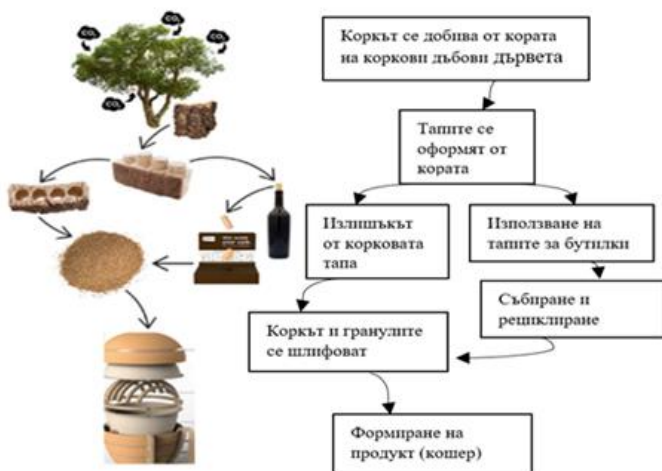
Фиг. 3. Технология за добив на рециклиран корк [16].
