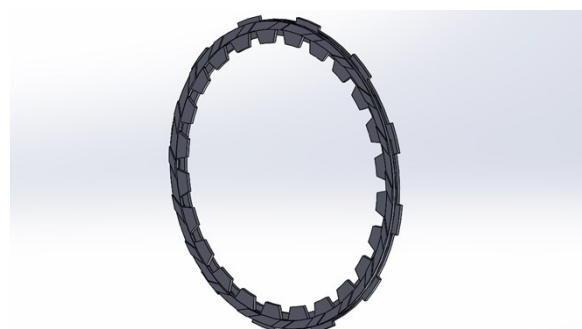
Фиг. 3. Триизмерен геометричен модел на една двойка дискове от спирачка C_1
