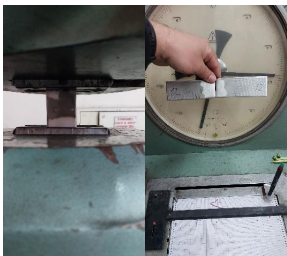
Фиг. 4. Закрепване на образца и отчетена стойност
